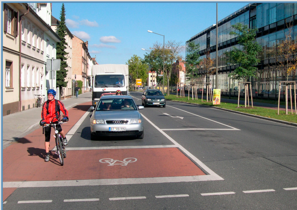
Per "casa avanzata" si intende lo spazio di attesa previsto davanti alla corsia degli autoveicoli nel quale le bici si attestano nella fase di rosso e in attesa del verde per poter partire davanti agli autoveicoli e godere di una situazione di maggior visibilità e sicurezza nell'effettuare l'attraversamento
