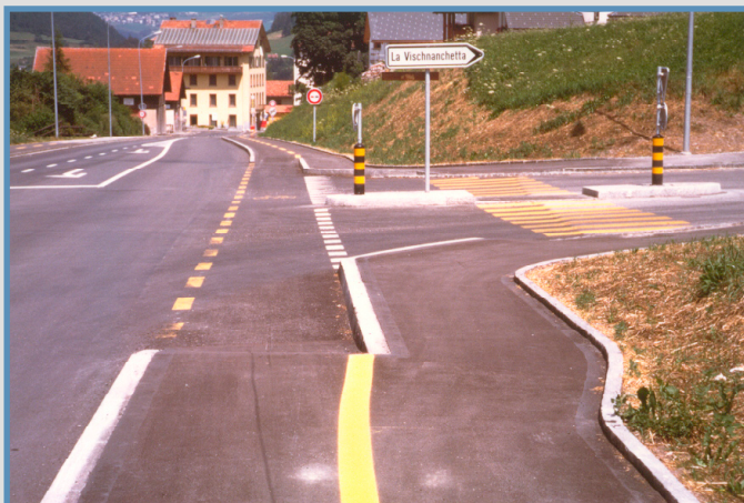
Francia, situazione ottimale, la bici da sede propria diventa corsia ciclabile nell'intersezione e passa davanti, la componente pedonale passa dietro A lato schema funzionale tratto da pubblicazione del Certu
