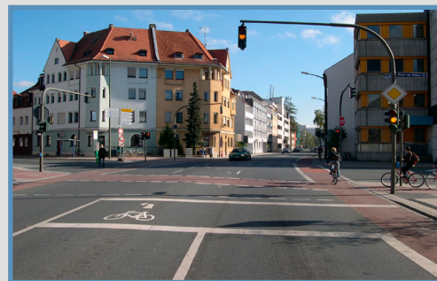
Caso con semaforo a fasi differenti per le due correnti di traffico
