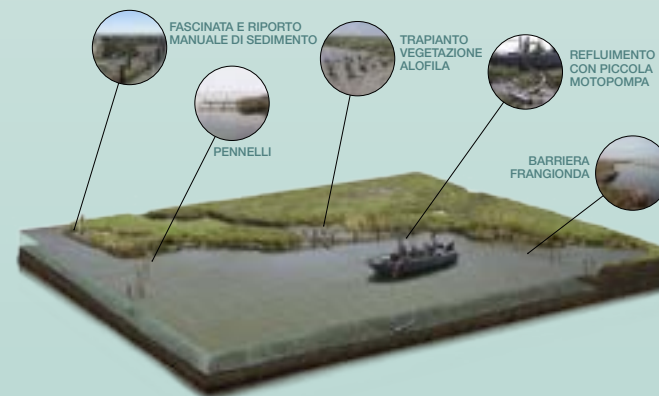
Esempi degli interventi d'ingegneria naturalistica
