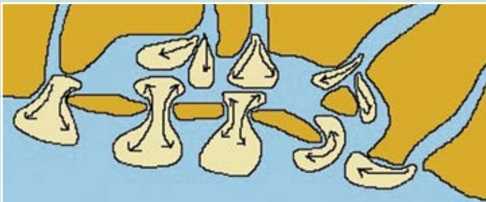
I fiumi apportano sedimenti che contribuiscono alla costruzione dei lidi che separano la laguna dal mare. Le frecce indicano lo scambio (rappresentato in giallo chiaro) d'acqua e sedimenti fra il mare e la laguna
