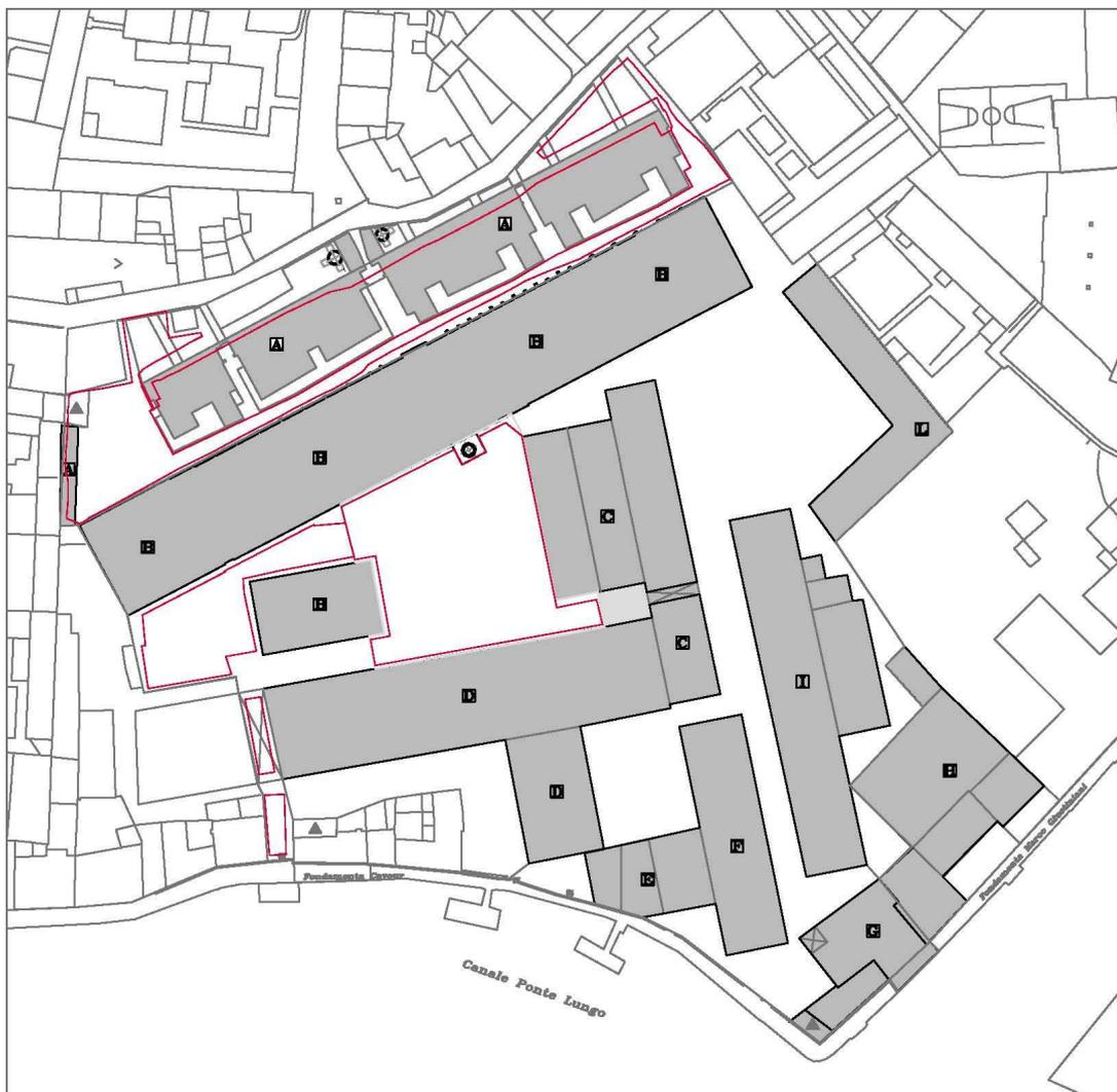
Figura 10.8: perimetro delle aree impermeabilizzate – stato di fatto (primo e secondo lotto)
