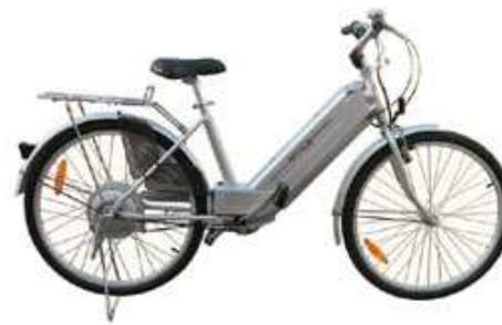
UN PARTICOLARE TIPO DI BICICLETTA È QUELLA A **PEDALATA ASSISTITA**, PERCHÉ SIA TALE IL MOTORE ELETTRICO AUSILIARIO DEVE AIUTARE IL CONDUCENTE NELLA PEDALATA... NON APPENA SI SMETTE DI PEDALARE LA BICICLETTA SI FERMA! IL MOTORE DEVE AVERE UNA POTENZA MASSIMA DI 0,25 KW E PUÒ RAGGIUNGERE AL MASSIMO I 25 KM/H.
