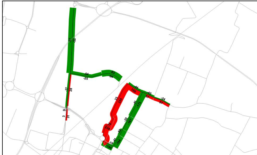
Figura 33 - Differenziali di traffico relativi alla messa a doppio senso di marcia di Santa Maria dei Battuti
