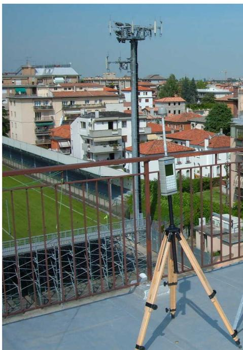
Fig. 1: *Strumentazione per misure a banda larga.*
