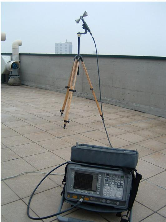
Fig. 2: *Strumentazione per misure a banda stretta – analizzatore di spettro e antenne.*
