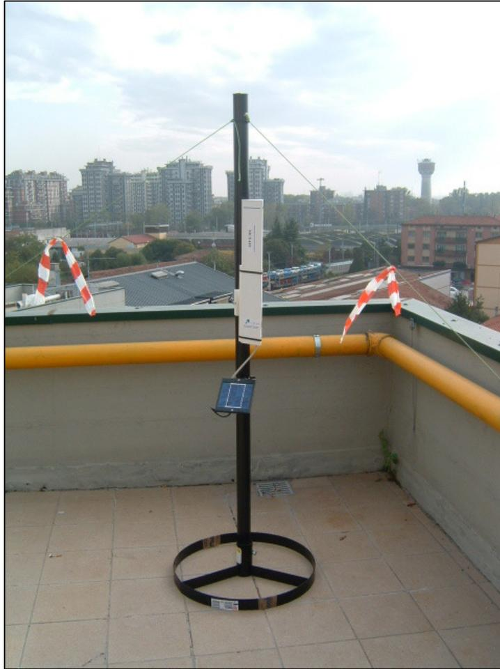
Fig. 4: Stazione di misura rilocabile EIT MCE410 - LARGA BANDA.
