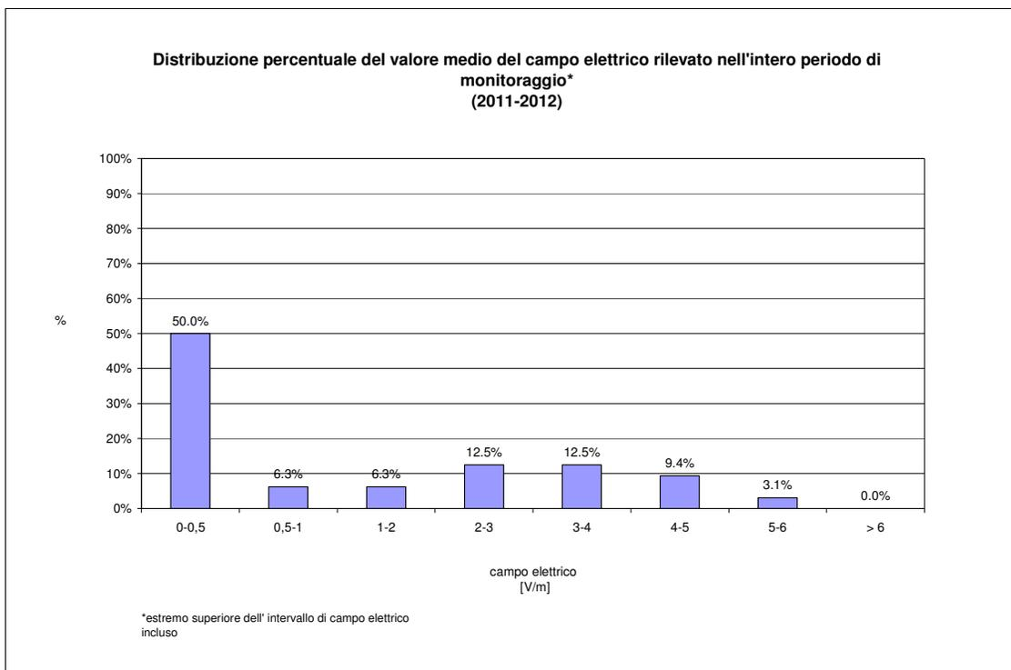
**Figura 19: Distribuzione percentuale del valore medio del campo elettrico rilevato nell'intero periodo di monitoraggio<sup>3</sup> (2011 - 2012)**
