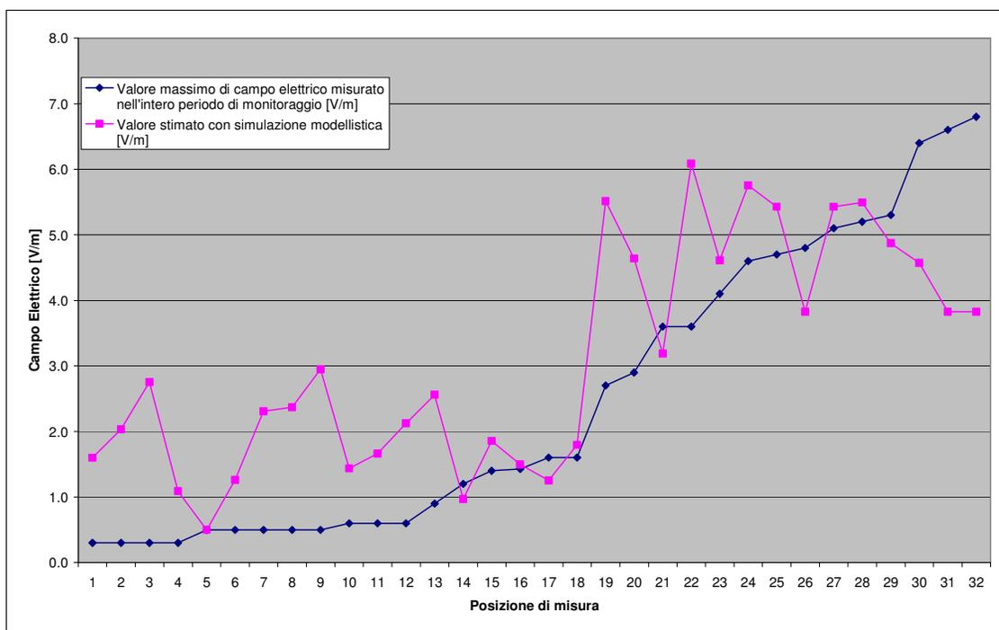
**Figura 21: Confronto tra la simulazione modellistica e il valore massimo di campo elettrico<sup>5</sup> rilevato durante le campagne di monitoraggio del biennio 2011 - 2012**
