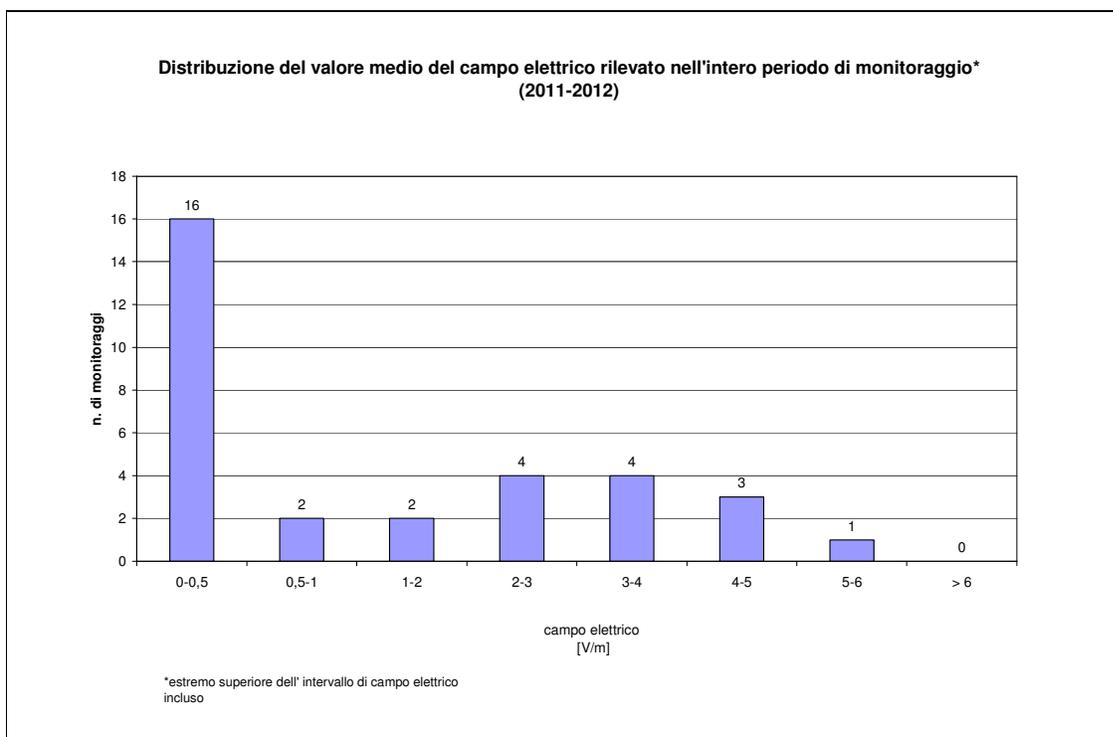
**Figura 18: Distribuzione del valore medio del campo elettrico rilevato nell'intero periodo di monitoraggio<sup>2</sup> (2011 – 2012)**
